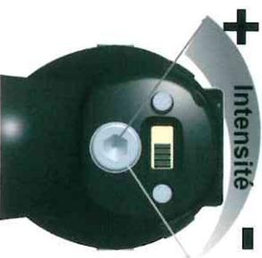
La fréquence de martèlement est inversement proportionnelle au réglage de l'intensité. Le réglage d'une intensité de percussion élevée réduit le nombre de percussions par seconde, alors que celui d'une intensité de percussion faible accroît le nombre de percussions par seconde.
