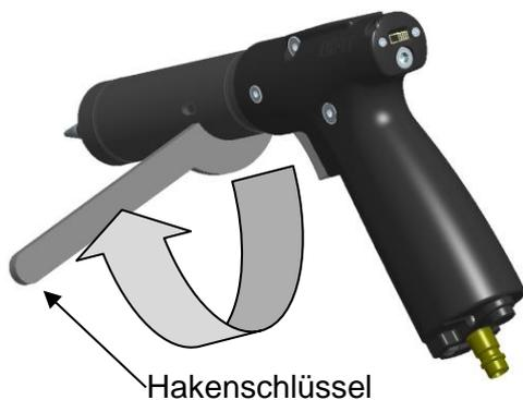
Drücken Sie die Spitze leicht gegen die Überwurfmutter und drehen diese im Uhrzeigersinn. Drehen Sie die Überwurfmutter bis Sie spüren, dass die Spitze anliegt.
