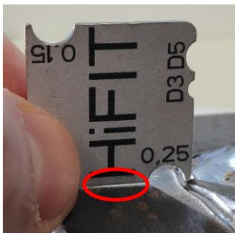
Setzen Sie nun die Messlehre mit der 0,25mm Spitze in die Nut. Entsteht ein Spalt an der unteren Fläche der Messlehre (siehe Abbildung links) ist die Nut in Ordnung, da nicht zu tief.
