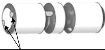
Zwei Bohrungen müssen sichtbar sein
