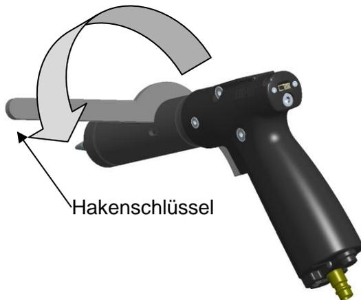
Zum Lösen der Überwurfmutter halten Sie das Gerät mit der Spitze von sich weg.
