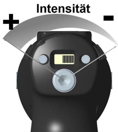
Die Intensitätseinstellung ist leichtgängig um ca.  $2\frac{1}{4}$  Umdrehungen mittels Innensechskantschlüssels ( im Lieferumfang enthalten) verstellbar. Der rechte Anschlag ist für Materialfestigkeiten unter S355, der Bereich der Mittelstellung bis zum linken Anschlag für Festigkeiten von S690 und höher vorgesehen.
