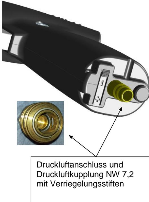
Um das Gerät mit Druckluft zu versorgen, nehmen Sie das Gerät in die eine und den Druckluftschlauch mit dem Kupplungsstecker in die andere Hand. Führen Sie den Kupplungsstecker axial, bis zum Anschlag, über den Druckluftanschluss des Gerätes. Dies erfordert etwas Kraft.
