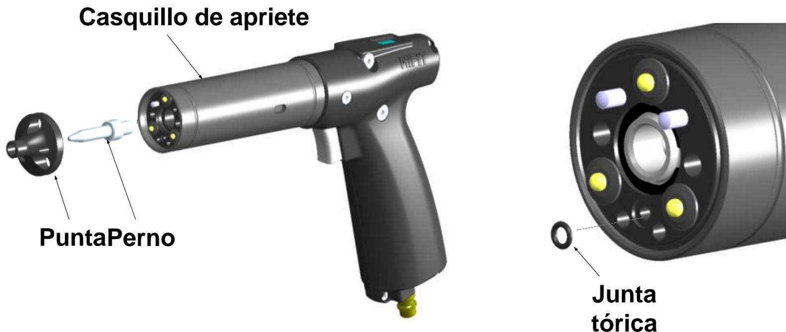
Después de soltar el casquillo de apriete, extraiga la punta y el perno del equipo. Sustituya el perno desgastado por uno nuevo e insértelo en la punta. Controle la junta tórica situada debajo de la guía del perno (vea imagen de la derecha) y sustitúyala en caso necesario. Deslice el casquillo de apriete hacia atrás y coloque la punta con cuidado en el equipo con el perno nuevo.
