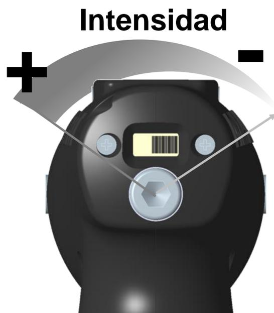
La frecuencia de martilleo varía de manera inversamente proporcional al ajuste de la intensidad. Esto es, si se ajusta una intensidad de impacto alta, el número de impactos por segundo disminuye. Por el contrario, si se ajusta una intensidad de impacto más baja, el número de impactos por segundo aumenta.
